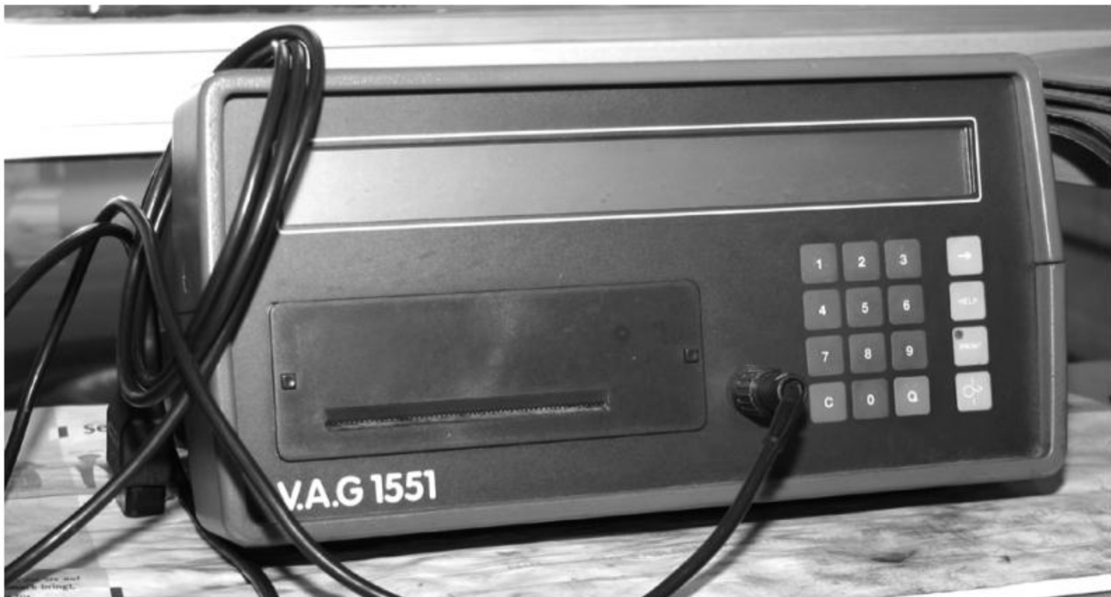
Abbildung 2.6: Professionelles älteres Werkstatt-Diagnosegerät mit Textdisplay und Belegdrucker.
