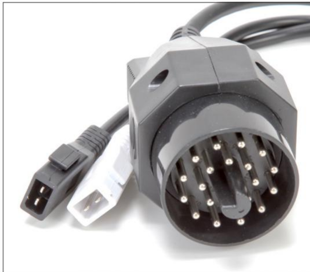
Abbildung 2.7: Proprietäre Diagnosestecker von VAG und BMW.
