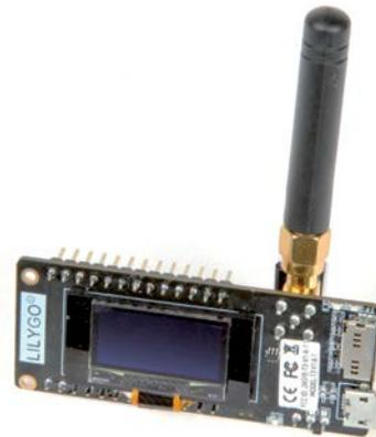
**Auf der einen Seite der Platine des TTGO LoRa32 befindet sich das Display und sogar ein verkürzter Steckplatz für microSD-Speicherkarten.**
