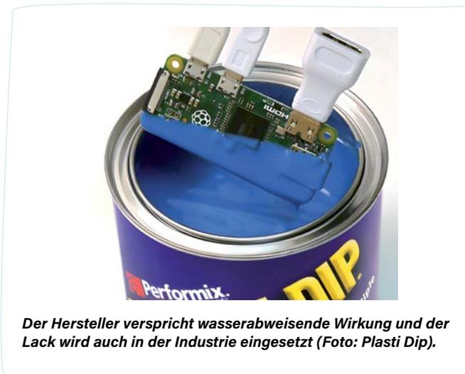
**Der Hersteller verspricht wasserabweisende Wirkung und der Lack wird auch in der Industrie eingesetzt (Foto: Plasti Dip).**
